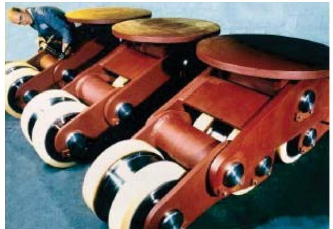
Rotantes pivotantes con pletina direccional. Formados por 4 ruedas de  $\phi 505\text{ mm}$ . de doble pestaña, con núcleo de acero y banda de Vulkollan® (antihidrólisis). Ejes de acero inoxidable girando sobre casquillos de bronce fosfatados.
